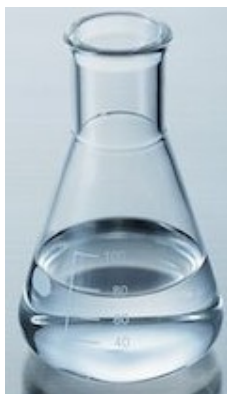
(b) En 150 ml konisk kolbe, der bruges blandt andet til at have prøven i under titreringen
